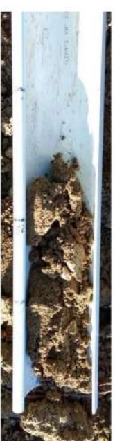
Restitution du profil de sol du sondage 1
